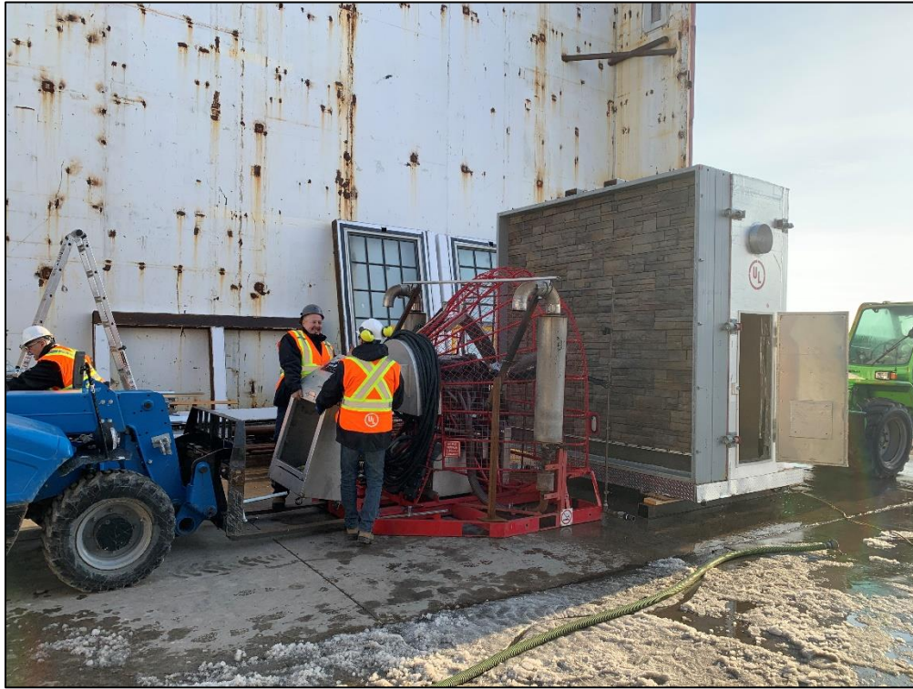
C-09 Mobilisation pour essai de résistance à la pluie sous pression dynamique
