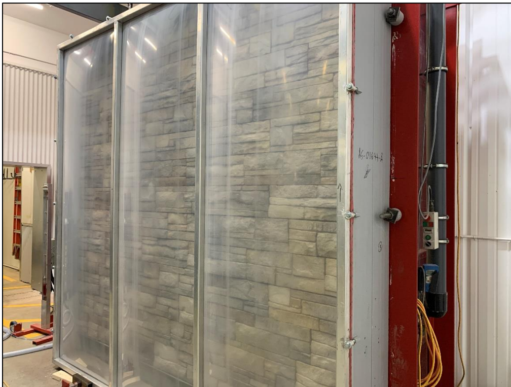
C-02 Prise des mesures de fuites du banc d'essai lors des essais d'étanchéité à l'air
