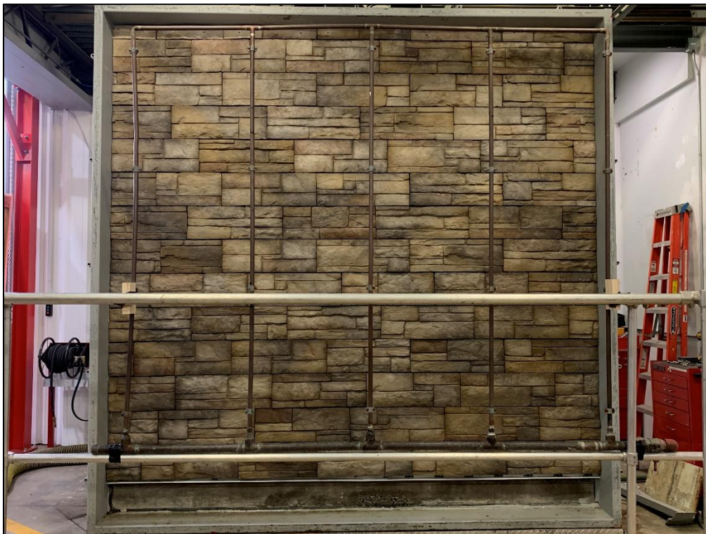
C-06 Essai de résistance à la pluie sous pression statique
