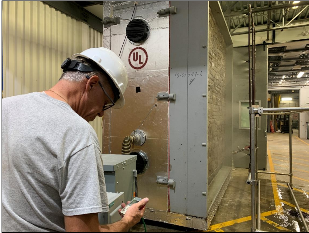
C-05 Essai de résistance à la pluie sous pression statique
