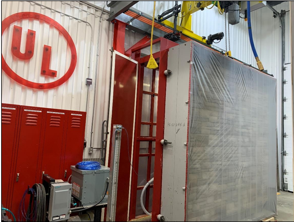
C-01 Essai d'étanchéité à l'air
